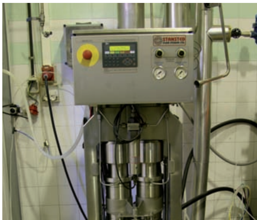
Equipo UHPH, el Stansted FPG 11300, capaz de soportar presiones de hasta 400 MPa
